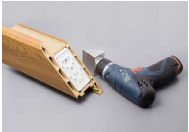
6. Flügel fertig zum Verschweißen
