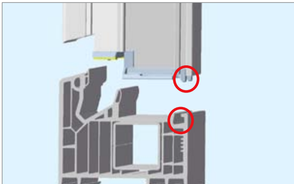
1. Führungsnasen in Nut setzen.
